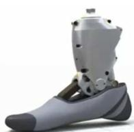
Vom US-Unternehmen **iWalk**, gegründet aus dem **Massachusetts Institut of Technology** aus Cambridge, kommt der **BioM**. Der BioM ahmt die Funktion der Wadenmuskulatur, der Achillessehne und des Sprunggelenks nach. Winkel-, Drehmoment- und Drucksensoren erfassen 250-mal pro Schritt, wie stark das künstliche Fußgelenk gestreckt oder gebeugt wurde. Eingebaute Prozessoren berechnen die weitere Bewegung und passen den Gang auch an unebenes Gelände, Rampen oder Treppen an. Das Gewicht
