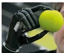
Die **i-limb ultra**-Hand von **Touch bionics** vertrieben durch **REHA-ORTHO Neuhof**, mit ihren fünf aktiv beweglichen Fingern machen es laut Hersteller bei dieser myoelektrischen Hand möglich, einen Gegenstand mit allen Fingern zu greifen und sicher festzuhalten. Die Elektronik erhöht die Griffkraft stufenweise, Finger für Finger, wenn der Patient bei gegriffenen Objekten weiter nachgreift.
